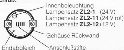
Anschluß erfolgt über Flachstecker A 2,8-0,5
